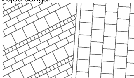
Trinkelų rašto pavyzdys (sujungimas su esamo šaligatvio danga) – detalizuoti DP metu
