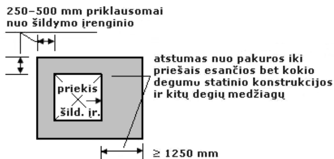
Pav. 4. Atstumo tarp šildymo įrenginio ir statinio konstrukcijos ir kitų degių medžiagų nustatymo principas
