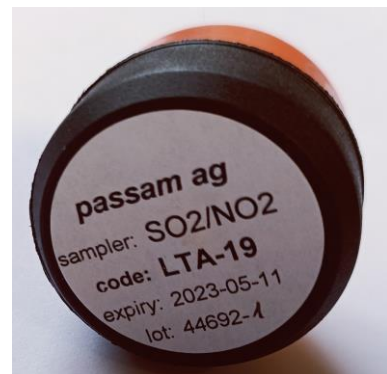
1.9 pav. Sieros dioksido/azoto dioksido difuzinis ėmiklis
