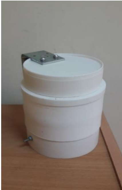
1.4 pav. Difuzinių ėmiklių tvirtinimo įrenginys
