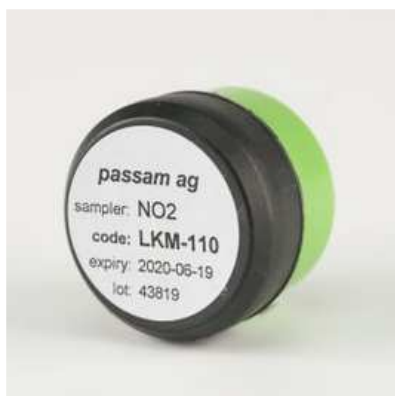
1.10 pav. Azoto dioksido pasyvusis sorbentas (kaupiklis)
